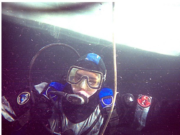
Испытания гидрокombineзона под водой
