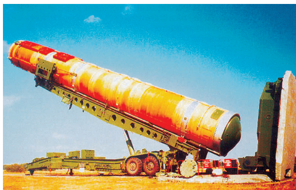
Загрузка транспортно-пускового контейнера с тяжёлой МБР Р-36М УТТХ в шахтную пусковую установку
